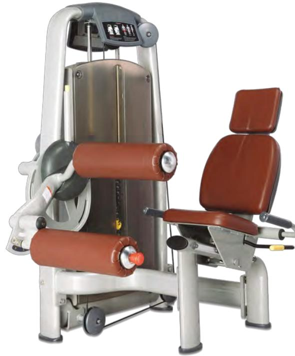
Профессиональный станок для выполнения упражнений на сгибание ног в положении сидя. Мощный овальный профиль станины 60\*120 мм. толщиной 2.5 и 3.0 мм. с двухслойной покраской. Общая надежность тренажера обеспечивается за счет использования только высококачественных компонентов. Тросовый блок состоит из надежных роликов с впрессованным высокоточным малолумным подшипником (тип 6202RS) и стального витого троса в PVC оболочке с общим диаметром 5.5 мм.
